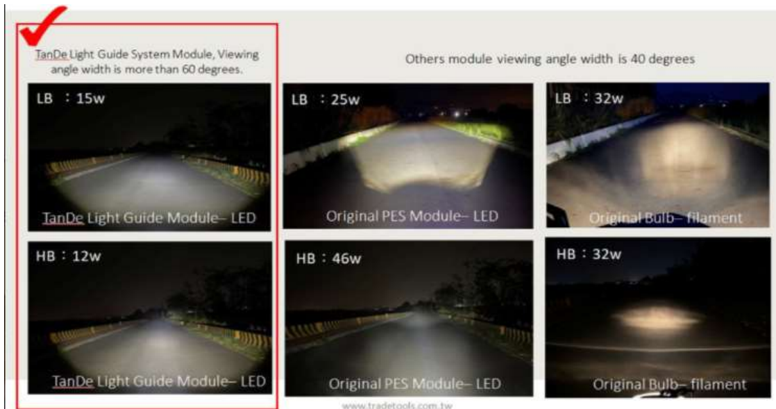
圖五：本公司機車頭燈總成與市售機車路照光形比對
